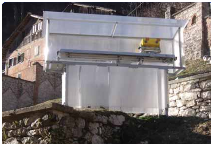
Figura 1 - Esempio di interferometro SAR terrestre modello IBIS-L installato su piattaforma QUIB™.
