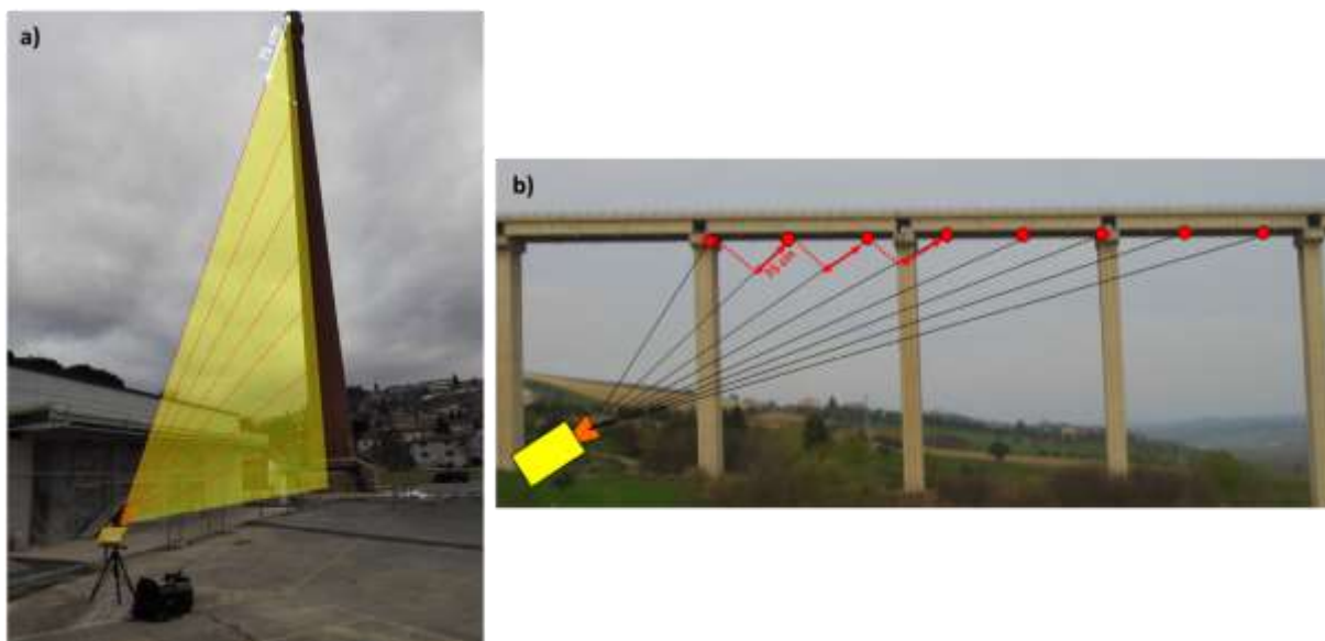
Figura 4: schema rappresentativo di alcune geometrie di monitoraggio TInRAR per diverse tipologie di strutture: a) torri; b) ponti.
